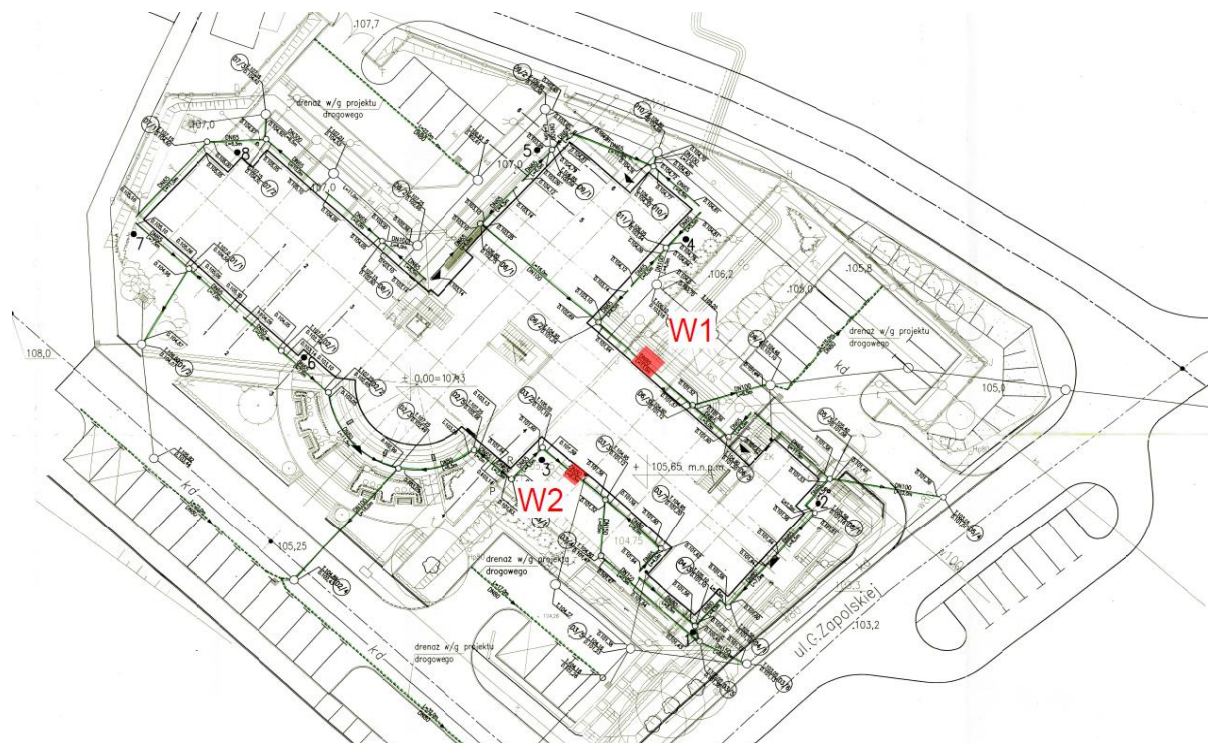
Rys. 10. Schemat rozmieszczenia miejsc odkrywek fundamentów
