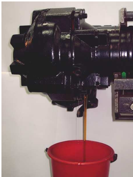
Opróżnianie komory olejowej
