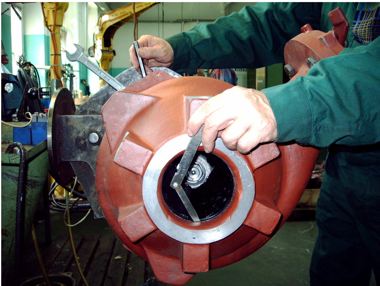
Regulacja szczeliny czołowej
