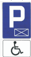
Ryc. 8.3. Znak pionowy D-18a (u góry) i Znak pionowy T-29 (na dole). (źródło: Rozporządzenie MI oraz MSWiA: 2002) [1].
