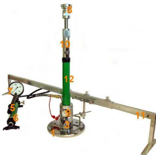
Rys. 1.2 Aparatura VSS z jednopunktowym pomiarem przemieszczenia płyty
