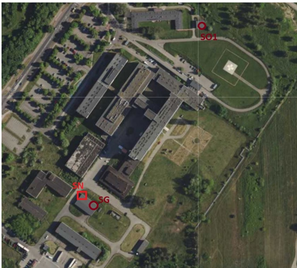
Rysunek nr 4. Umiejscowienie głównych punktów zasilania obiektu Szpitala.
