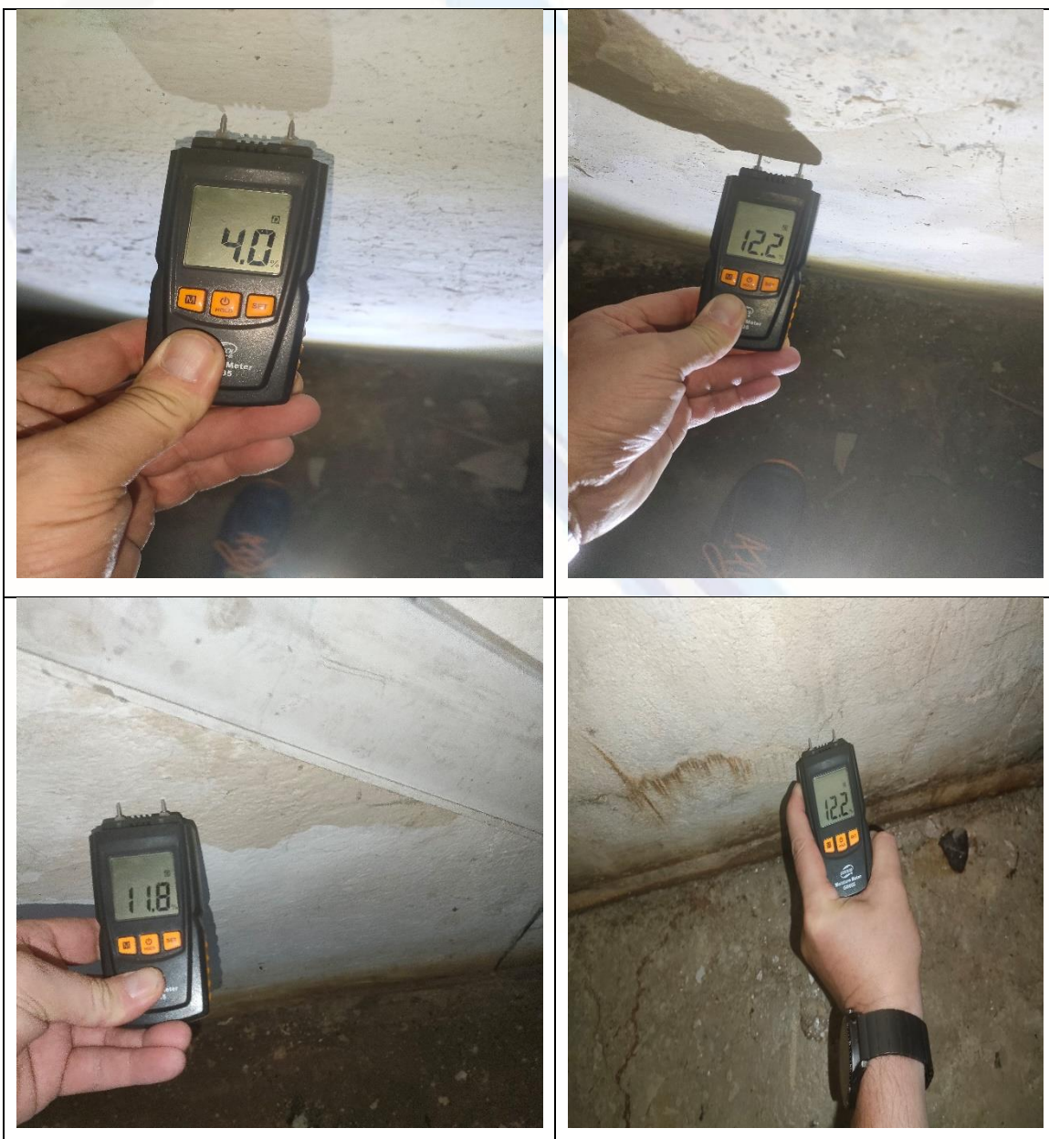
Fot. nr. 11,12,13,14 Pomiar wilgotności ścian piwnicznych
