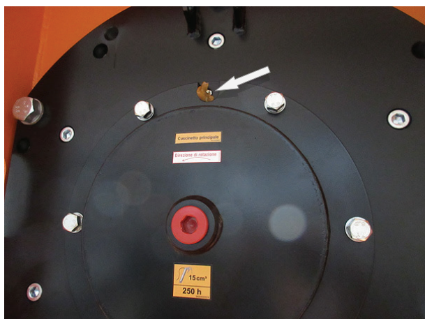
95 Smarowanie łożyska głównego walca rozdrabniającego (strona czołowa)
