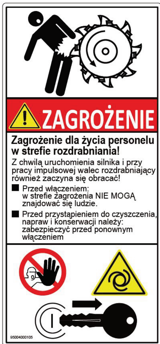
31 Zagrożenie przy uruchamianiu silnika i przy pracy impulsowej
