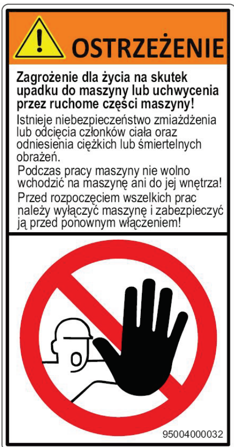
28 Ostrzeżenie przed upadkiem do maszyny lub uchwyceniem przez ruchome części maszyny
