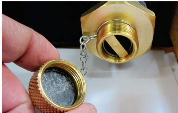
136 Spuszczanie oleju hydraulicznego
