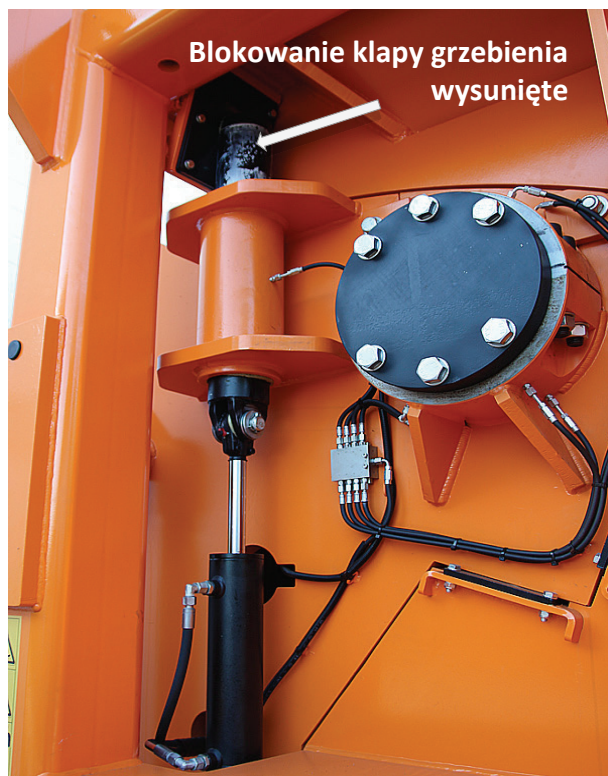
58 Blokowanie kłapy grzebienia
