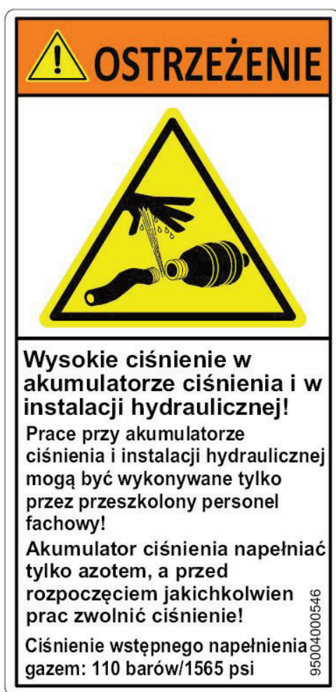
76 Ostrzeżenie przed wysokim ciśnieniem w akumulatorze ciśnieniowym i w instalacji hydraulicznej
