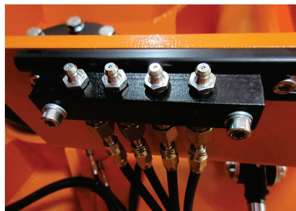
91 Smarowanie łożyskowania przekładni, po stronie napędu
