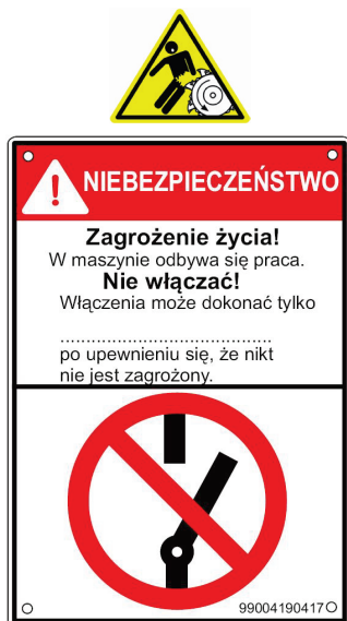
74 Tablica ostrzegawcza „Nie włączać maszyny!”
