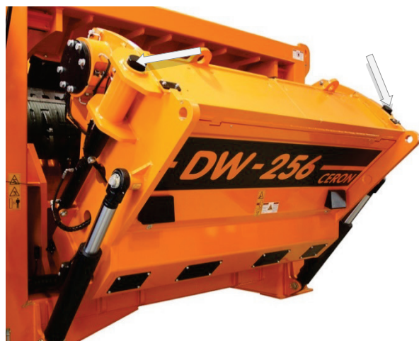
54 Odblokowanie kłapy grzebienia
