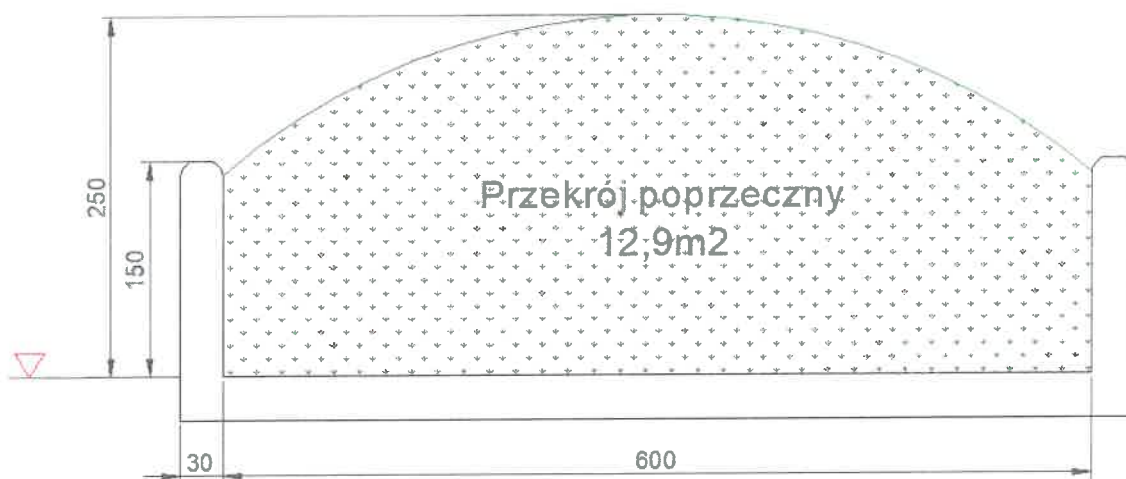
Rys. 5 – przekrój poprzeczny pryzmy w boksie
