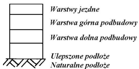
Rys. 3. Konstrukcja nawierzchni utwardzonego pobocza
