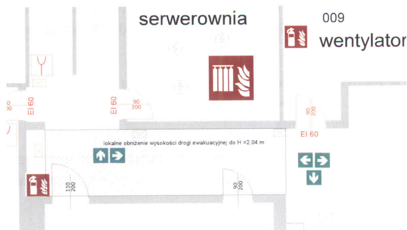
Rysunek nr 11. Lokalne obniżenie wysokości drogi ewakuacyjnej.
