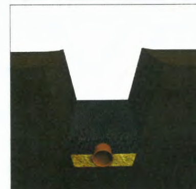
3. Obsypanie rury Leca® KERAMZYTEM izolacyjnym L
