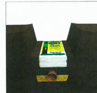
4. Przykrycie rur warstwą Leca® KERAMZYTU izolacyjnego L w workach
