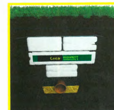
6. Folia przykrywająca izolację i wyrównanie terenu
