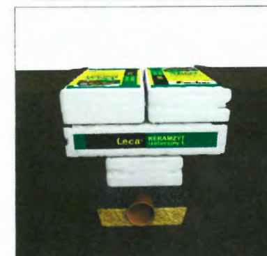
5. Przykrycie rur kolejnymi warstwami worków
