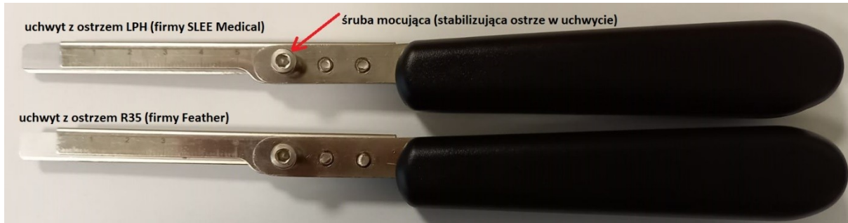
Fot.1 Uchwyt firmy Opta-Tech z zamocowanym ostrzem LPH firmy SLEE Medical (uchwyt u góry) oraz z zamocowanym ostrzem R35 firmy Feather (uchwyt u dołu)
