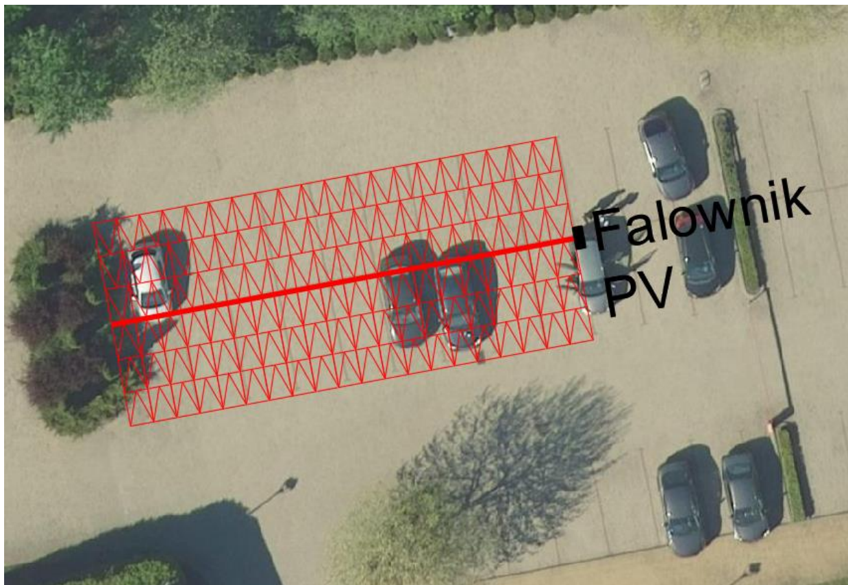
Rys. 3. Rozmieszczenie infrastruktury PV
