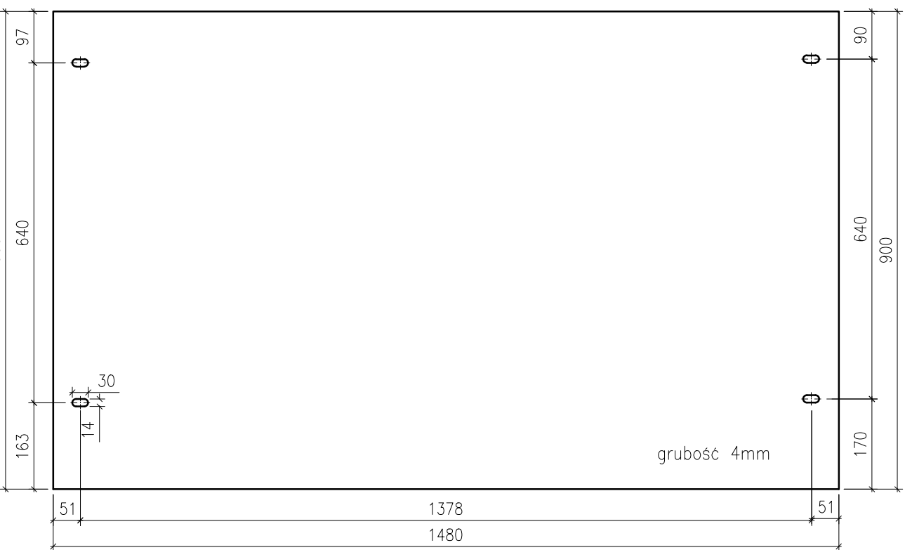
Ekran kompozytowy typ 2, 2 sztuki skala 1:10
