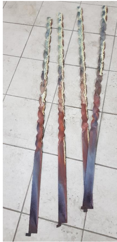
rys. 7 zawirowywacze spalin zostały wyciągnięte losowo. Są w całości do ewentualnego wyczyszczenia.
