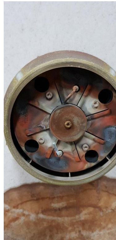
rys. 9 rura palnika i tarcza spiętrzająca posiada ślady pracy, natomiast brak pęknięć czy odkształceń termicznych.
