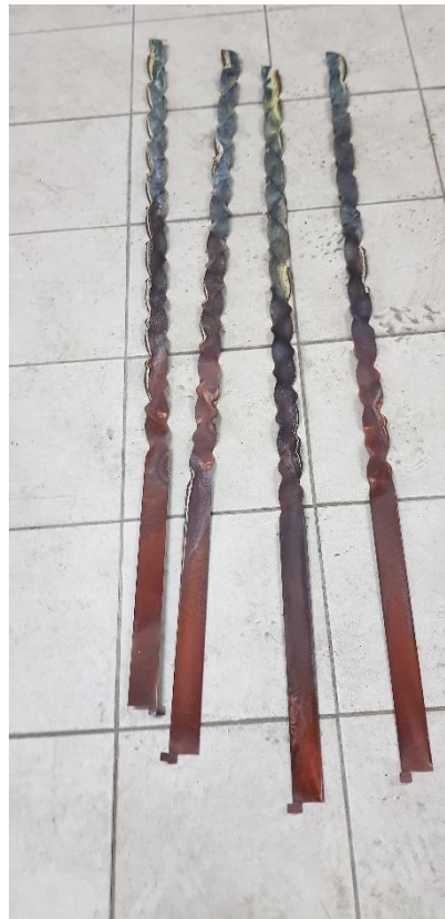
rys. 15 zawirowywacze spalin zostały wyciągnięte losowo. Są w całości do ewentualnego wyczyszczenia.
