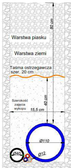
Przekrój wykopu otwartego z planowanym ułożeniem rur
