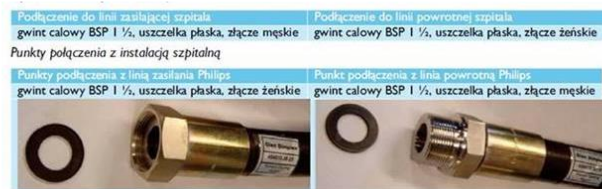
Rys. 5 Punkty połączenia z instalacją Philips
