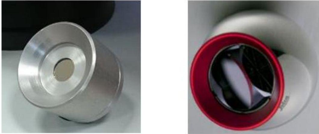
Rys. 10. Gniazdo punktu referencyjnego i Reflektor/ pryzmat pomiarowy 1'5".
