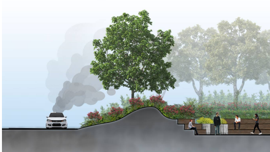
(rys.9) schemat izolacji od zanieczyszczeń
