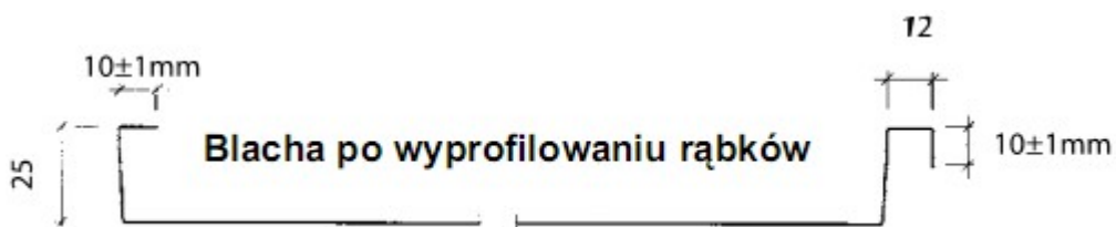
Rys. 7. Blacha po wyprofilowaniu rąbków.
