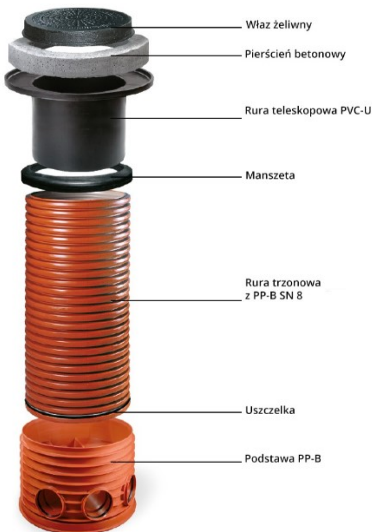
Rys. nr 2. Poglądowy schemat studzienki inspekcyjnej.
