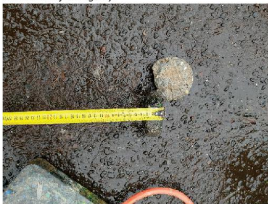
Zdj. nr 10. Próbką asfaltobetonu – otwór badawczy nr 4, ul. Łowicka
