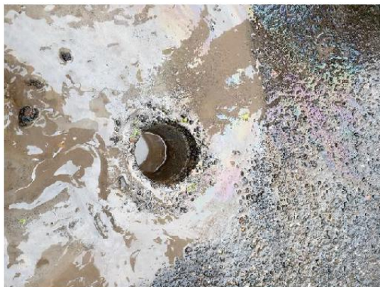
Zdj. nr 13. Próbką asfaltobetonu – otwór badawczy nr 6, ul. Łowicka (przekrusz z wiertnicy) Widok otworu badawczego.
