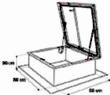
projektowany wyłaz dachowy 80x80
