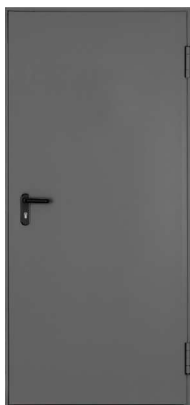
Drzwi stalowe jednoskrzydłowe 900x2050 gr. 60 mm malowane proszkowo z izolacją z wełny mineralnej wsp. przenikania ciepła U = 1,30 \text{ W/m}^2\text{K}
