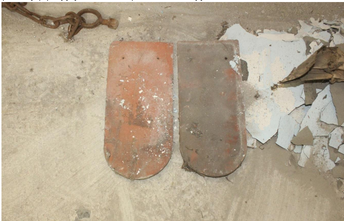
Fot. nr 20 Kaplica p.w. św. Szczepana z 1913 r. usytuowana na Starym cmentarzu w Ryglicach. Dachówki z pierwotnego pokrycia dachu w typie karpiówki o wymiarach 12,5cm/27cm znalezione wewnątrz kaplicy.
