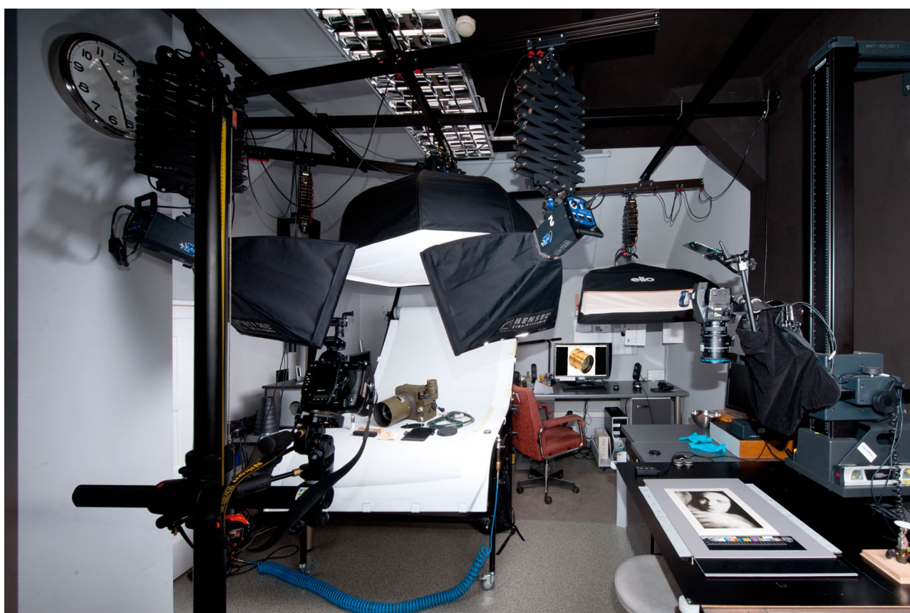
3.119. Ogólny wygląd stanowiska reprodukcyjnego ze studijnymi lampami błyskowej firmy Hensel i z zastosowaniem liniowych softboksów firmy ELFO. Taka konfiguracja światła pozwala na uzyskanie w niewielkiej pracowni równomiernego oświetlenia na powierzchni 60 x 90 cm. Pracownia Dokumentacji Obrazowej MHF. Fot. W. Staszkiwicz
