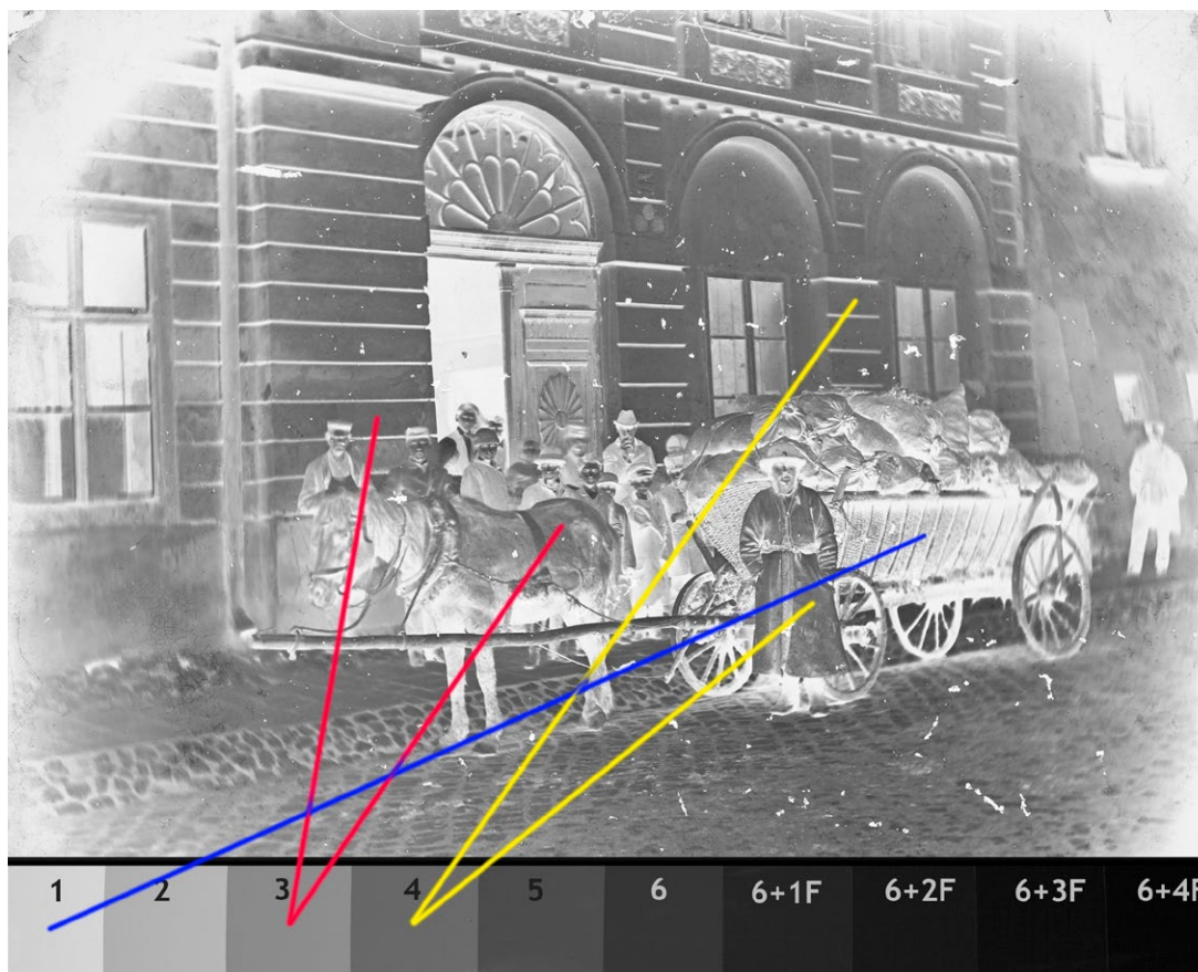
3.81. Negatyw szklany wraz z szarym klinem. Ogólne krycie określono jako normalne, czyli mieszczące się w środkowym zakresie. Kolorowymi liniami skojarzono podobne gęstości. Kolor czerwony – proponowany dolny zakres ustawienia flesza (wartość 3); kolor żółty – proponowany górny zakres ustawienia flesza (wartość 4); kolor niebieski – wskazany bezpieczny zakres cieni. Klisza została poprawnie odwzorowana przy ustawieniu wartości 3,8 na skali regulacji flesza. Negatyw ze zbiorów MHK. Opracowanie W. Pyzik
