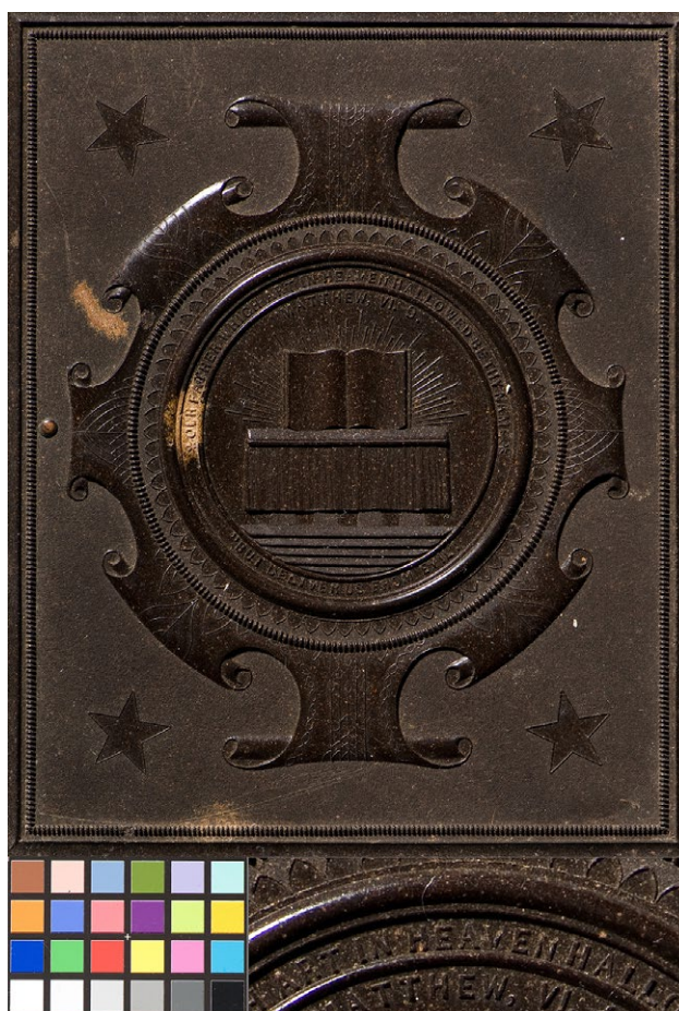
3.128. Powierzchnia pudełka z gutaperki, zdjęcie w oświetleniu bocznym punktowym źródłem światła spolaryzowanego zgodnie ze schematem zaprezentowanym na il. 3.127. Fot. W. Staszkiwicz
