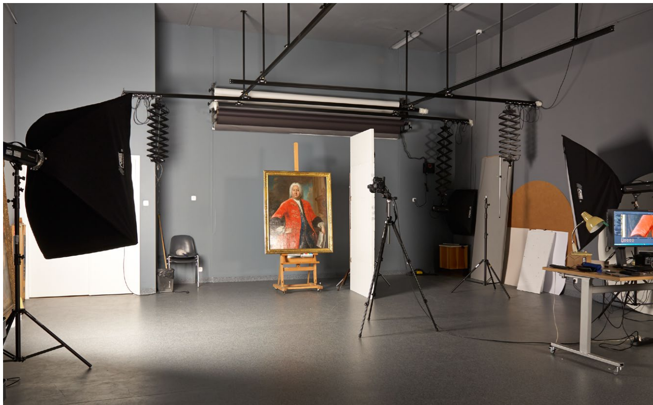
3.12. Studio fotograficzne Muzeum Narodowego w Gdańsku – plan zdjęciowy. Softboks 140 x 100 cm z lewej strony oraz ekran odbijający z prawej. Fot. G. Nosorowski
