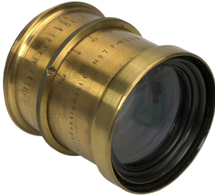
2.14. Obiektyw Hugo Mayera Aristostigmat 360 mm f/6,5 , opatentowany w 1900 r., ze zbiorów MHF. Fot. W. Staszekwicz
