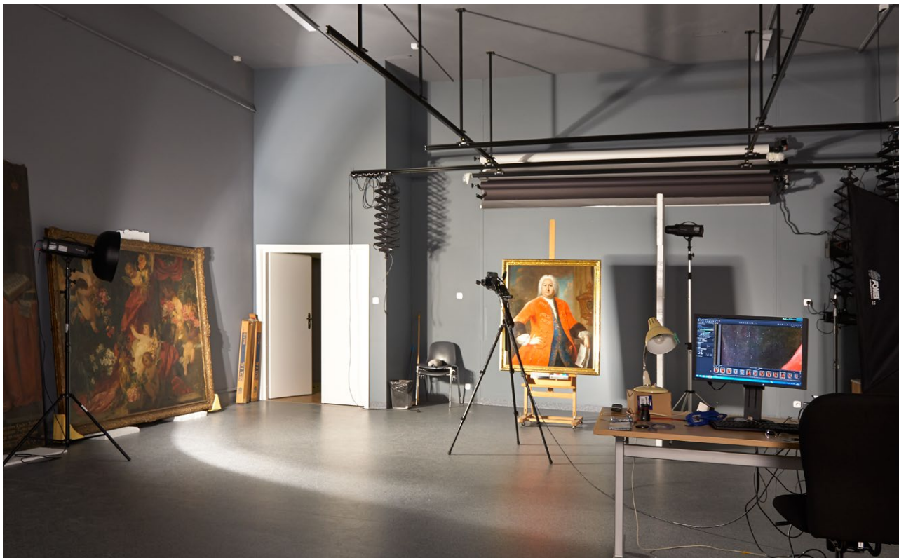
3.14. Studio fotograficzne Muzeum Narodowego w Gdańsku – plan zdjęciowy. Reflektor paraboliczny z lewej strony, ekran odbijający z prawej. Fot. G. Nosorowski
