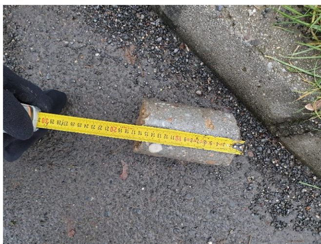
Zdj. nr 14. Próbką bet. cementowy – otwór badawczy nr 6, ul. Łowicka
