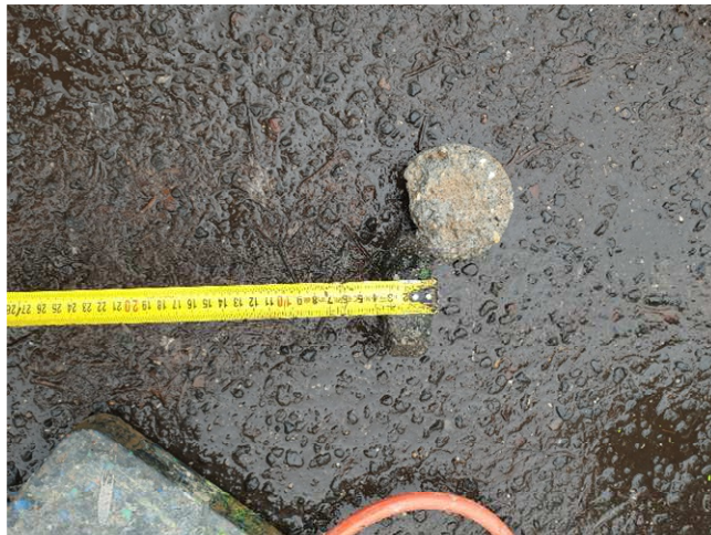
Zdj. nr 10. Próbkę asfaltobetonu – otwór badawczy nr 4, ul. Łowicka
