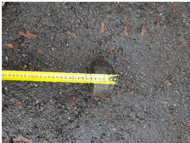
Zdj. nr 6. Próbkę asfaltobetonu – otwór badawczy nr 3, ul. Łowicka
