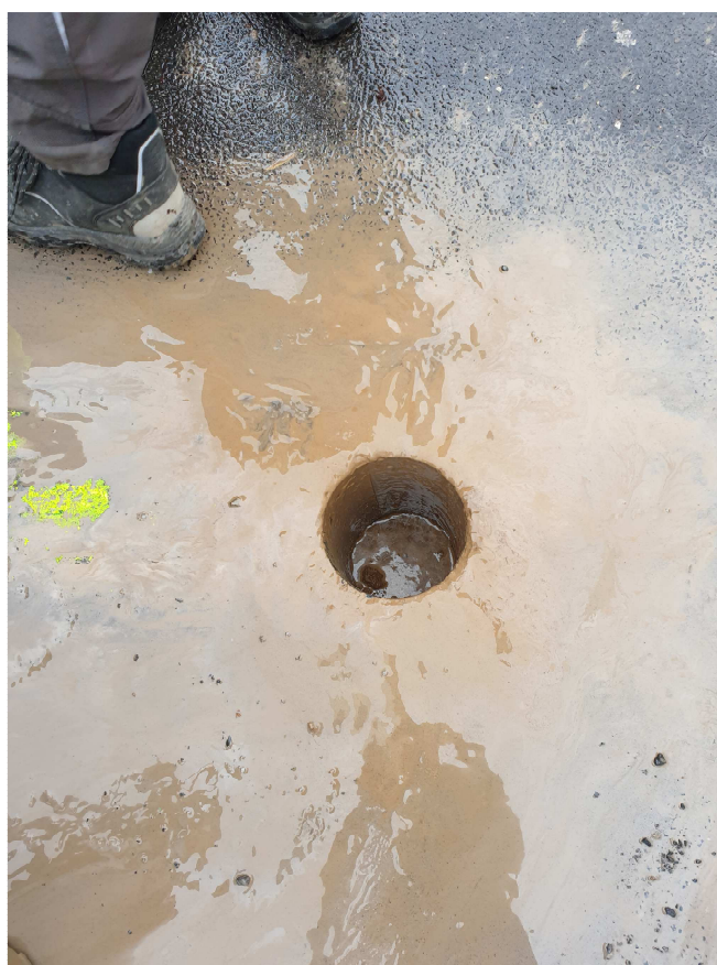
Zdj. nr 4. Widok otworu badawczego nr 1, ul. Śląska
