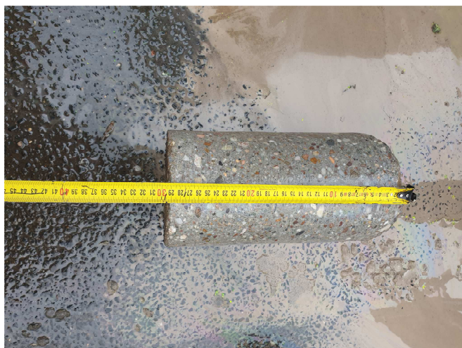
Zdj. nr 3. Próbkę bet. cementowy – otwór badawczy nr 1, ul. Śląska
