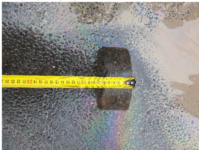
Zdj. nr 2. Próbkę asfaltobetonu – otwór badawczy nr 1, ul. Śląska
