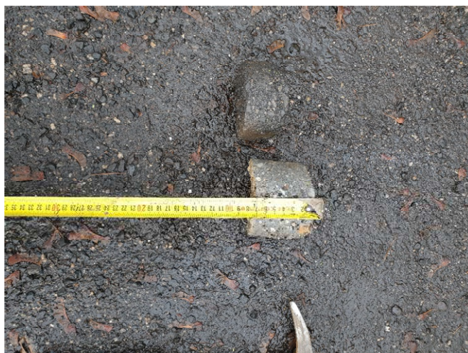
Zdj. nr 7. Próbkę bet. cementowy – otwór badawczy nr 3, ul. Łowicka (próbkę częściową, pozostałość próbki pokrusz z wiertnicy)
