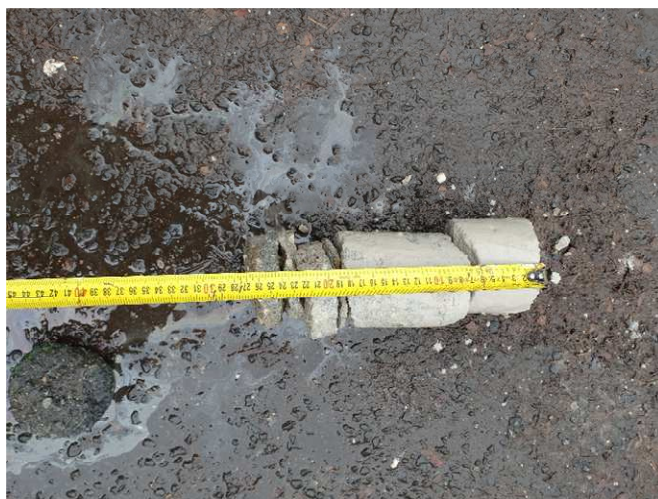
Zdj. nr 11. Próbkę bet. cementowy – otwór badawczy nr 4, ul. Łowicka
