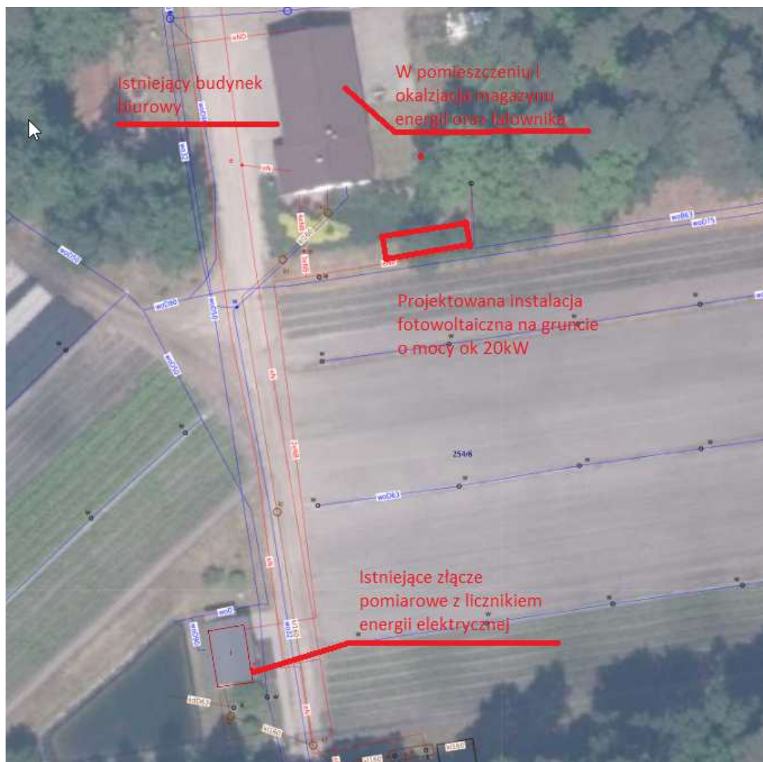
Rys.2 Mapa sytuacyjno-wysokościowa z lokalizacją instalacji PV, głównej rozdzielni budynku i złącza kablowego
