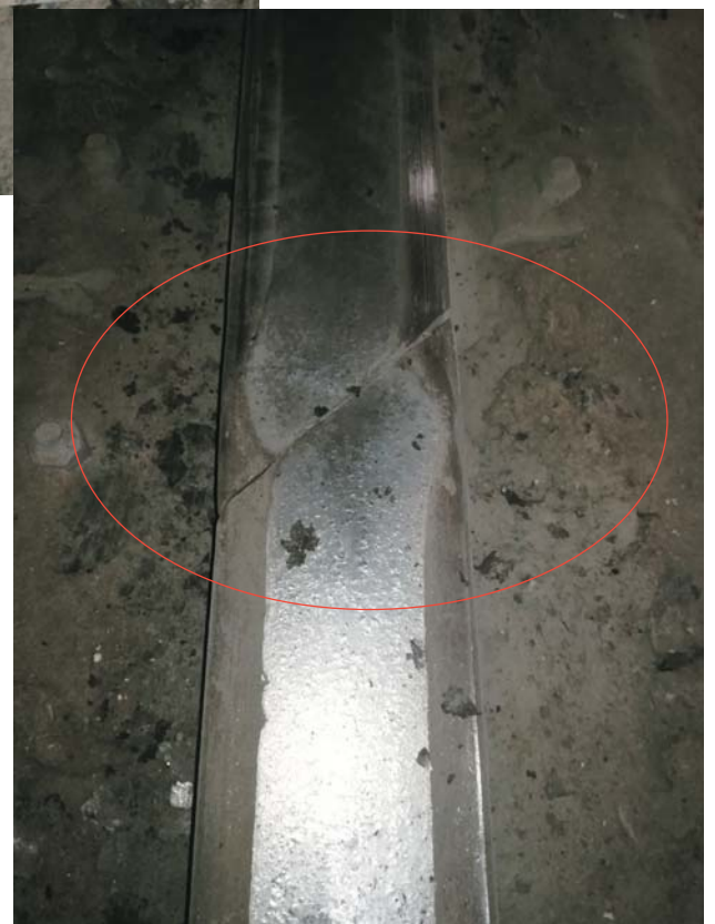
Elipsą oznaczono wzorec, przenoszony przez koło na powierzchni szyny jako cykliczny wzór. ( szyna północna )
