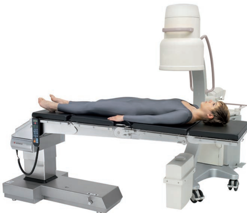
Pozycja odwrócona (maksymalne odsunięcie) stąd: przezierność dla promieniowania RTG na obszarze 1900 x 370 mm blat stołu o długości 1990 mm poza kolumną stołu w modelu schaeerer® axis 800.
