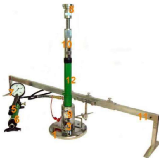
Rys. 1.2 Aparatura VSS z jednopunktowym pomiarem przemieszczenia płyty
