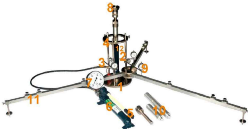
Rys. 1.1. Aparatura VSS z trzypunktowym pomiarem przemieszczenia płyty
