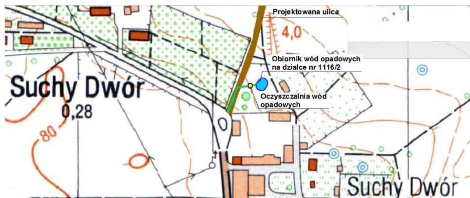
Rys. nr 8. Schemat odprowadzania wód opadowych na terenie Suchego Dworu
