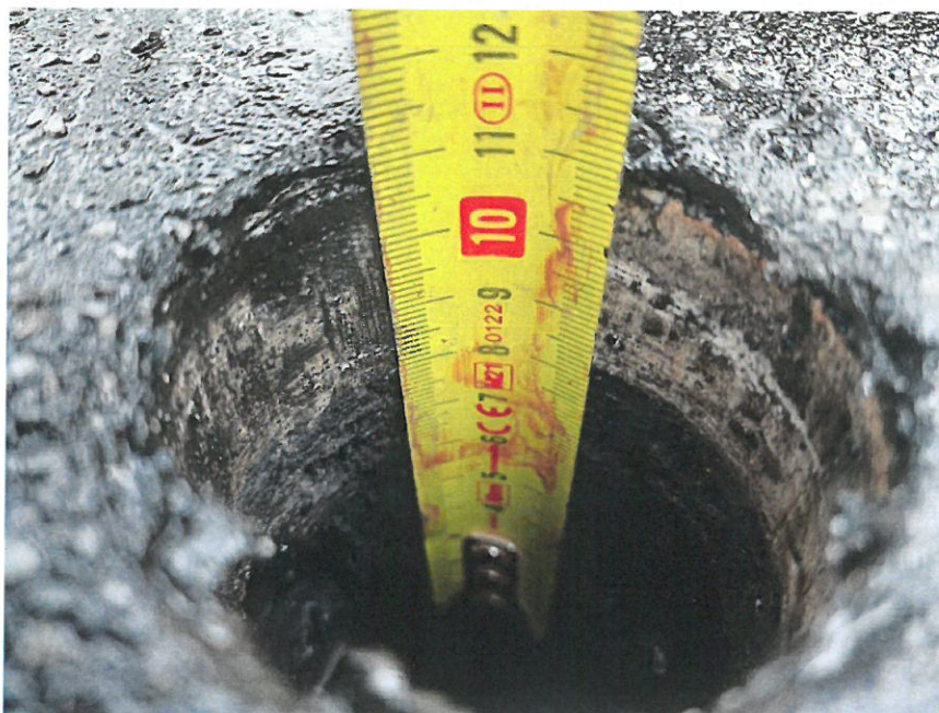
Fot. 8.4 Pomiar grubości górnych warstw na odwiercie rdzeniowym – odwiert nr 2
