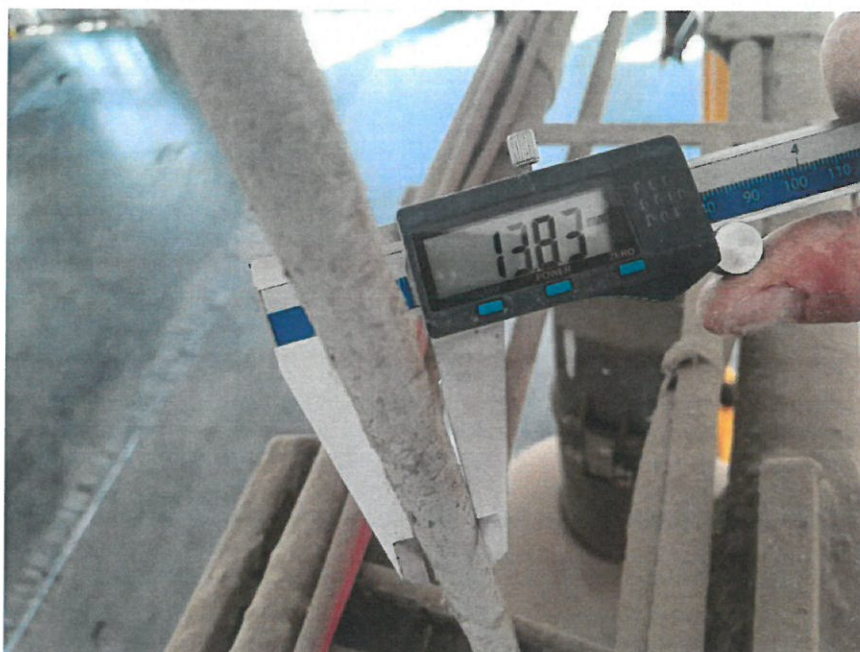
Fot. 8.18 Pomiar średnicy pręta konstrukcji wieszaka
