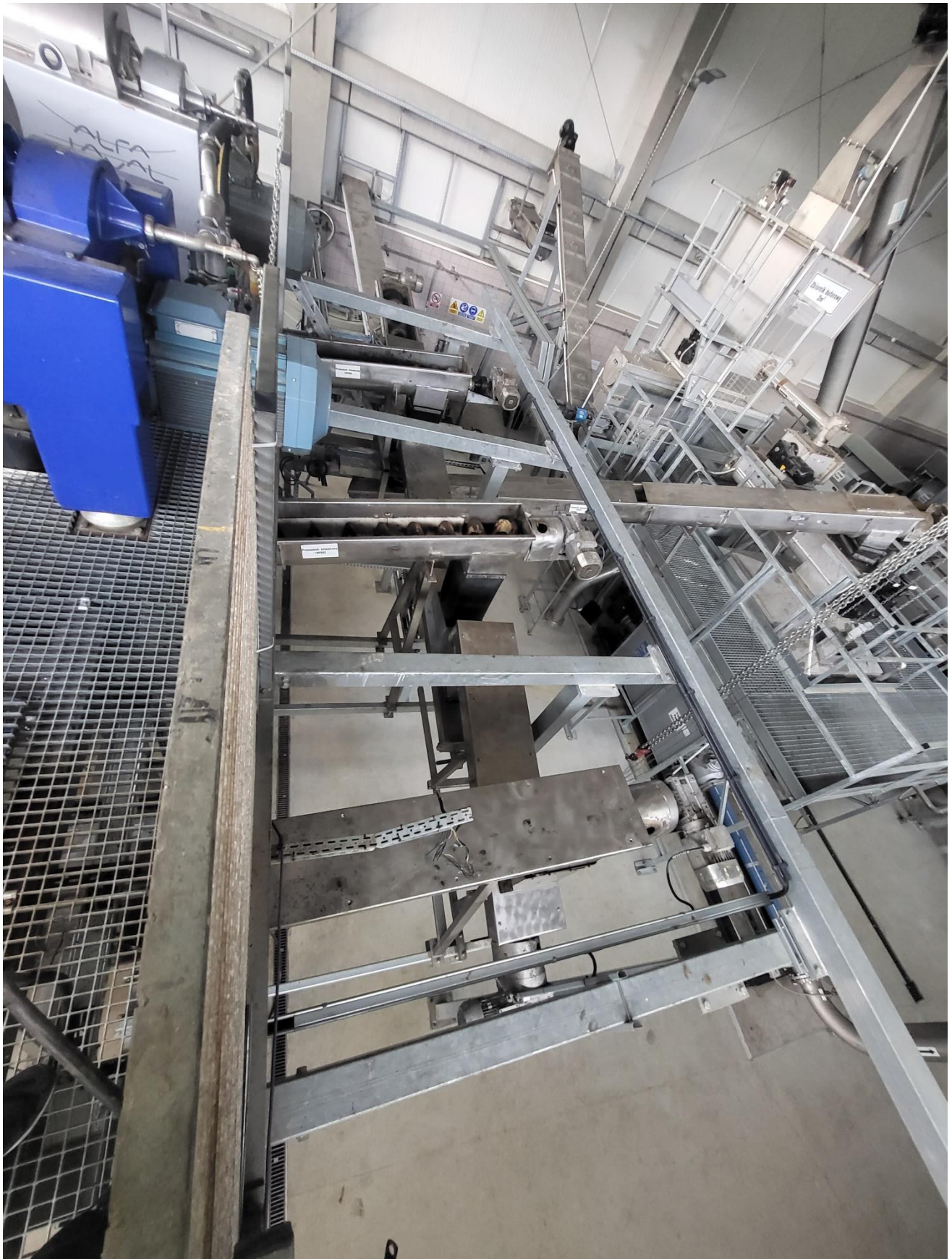
Zdj. 3 – widok zespołu przenośników z wirówek do zbiornika nadawy
