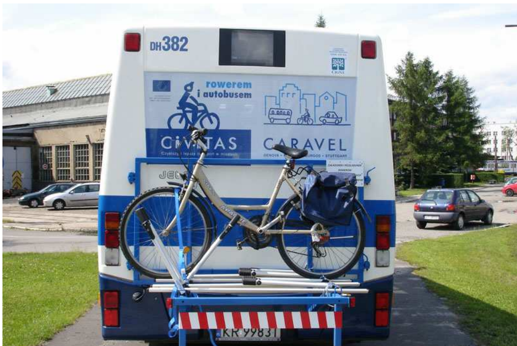
Rysunek 30 Przewóz rowerów na zewnątrz autobusu podmiejskiego w Krakowie
