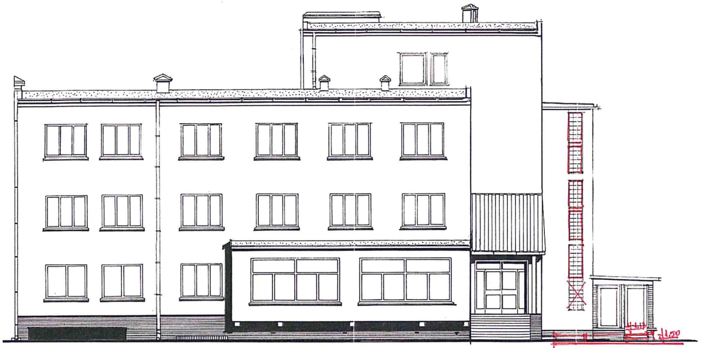
Rys.1: Zewnętrzny szymb dźwigu osobowego usytuowany przy budynku Wojewódzkiego Ośrodka Medycyny Pracy zlokalizowanego w Gdańsku przy ulicy Okrąg 1B-widok od strony ulicy Okrąg (na podstawie archiwalnej dokumentacji projektowej)
