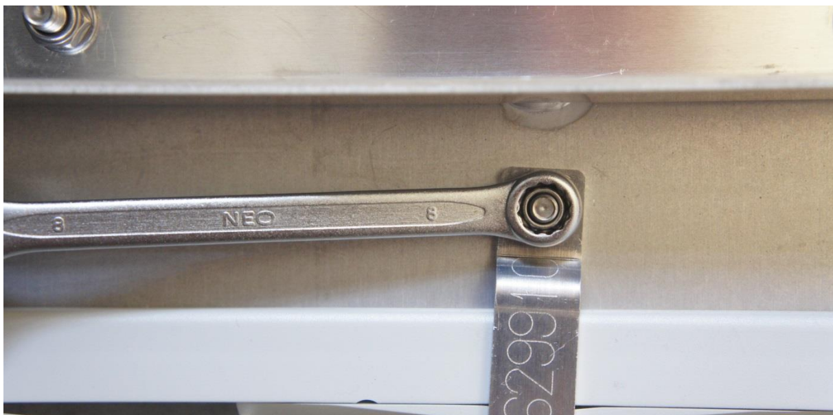
Rys. Poluzować nakrętkę od zabezpieczenia obudowy filtra. Zastosować klucz „8”.
