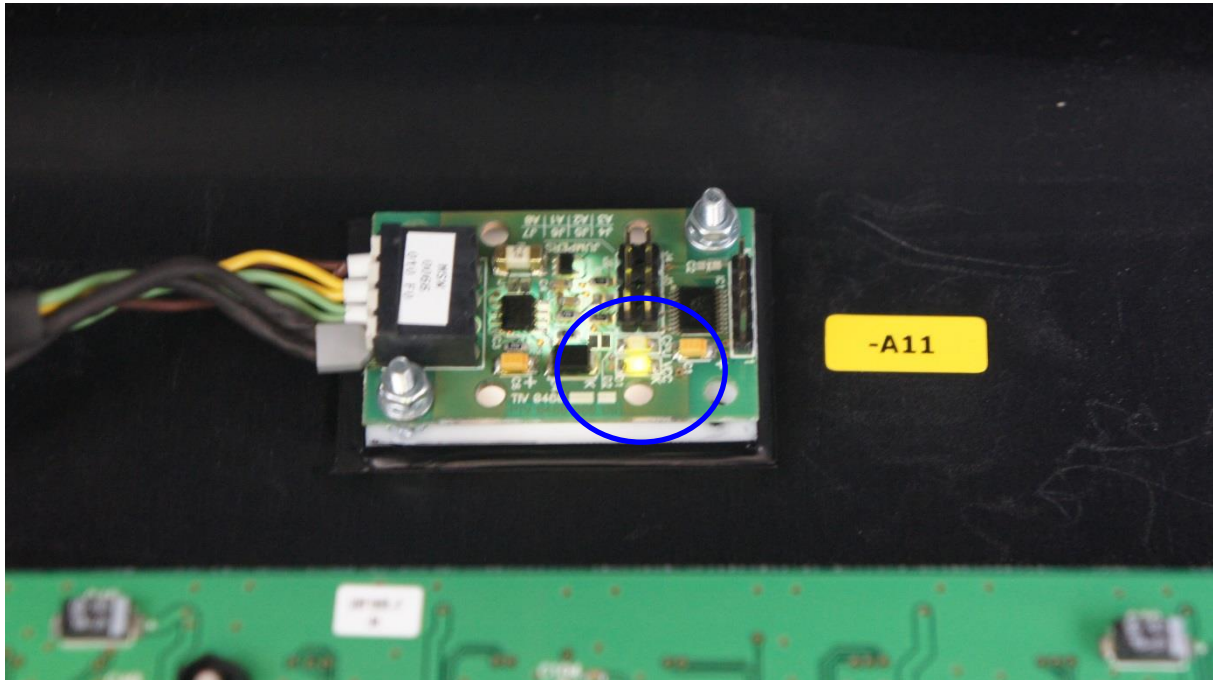
Rys. Czujnik oświetlenia – wnętrze znaku. Sprawdzić czy mrugają diody.
