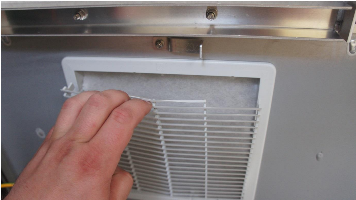
Rys. Pociągnąć do siebie kratkę obudowy filtra.
