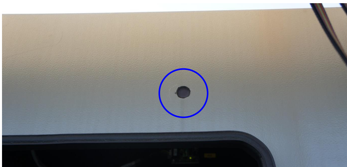
Rys. Czujnik oświetlenia z zewnątrz. Sprawdzić czy czujnik nie jest zabrudzony – jeśli zabrudzony przetrzeć wilgotną szmatką
