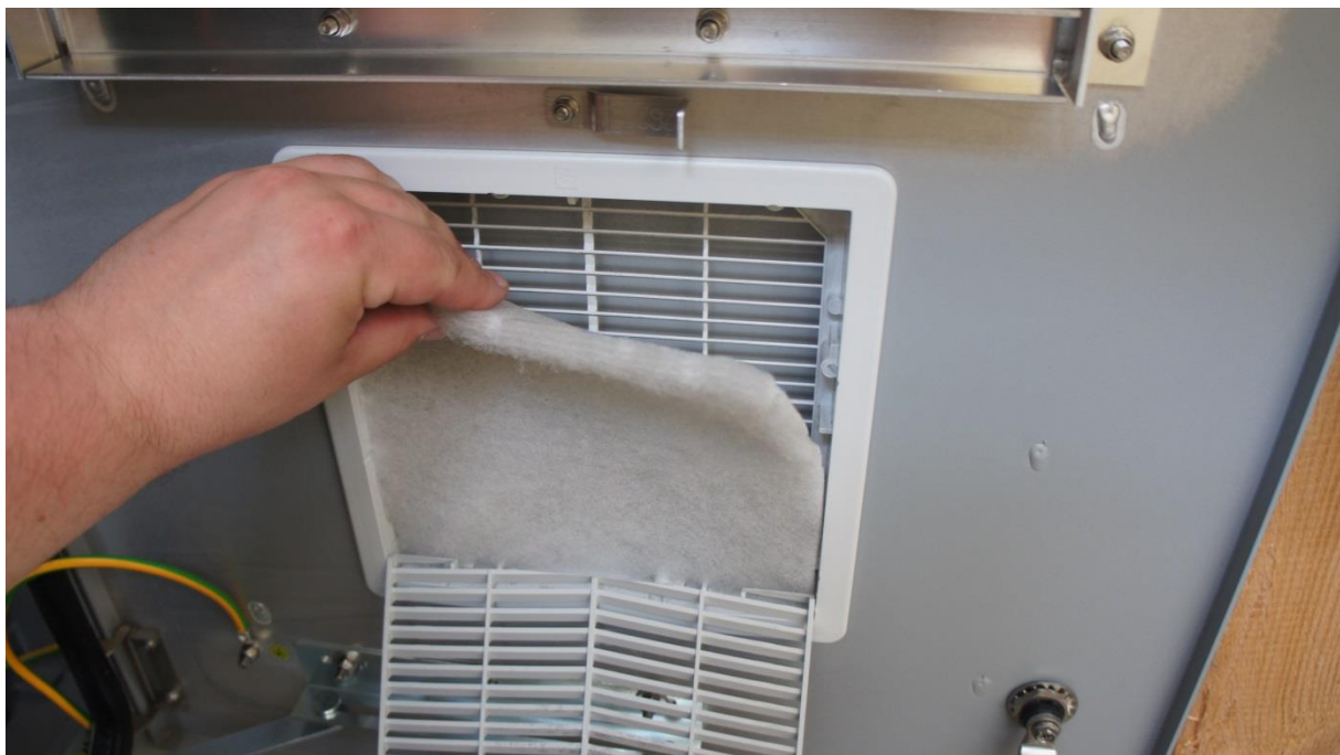
Rys. Pociągnąć do siebie kratkę obudowy filtra.
