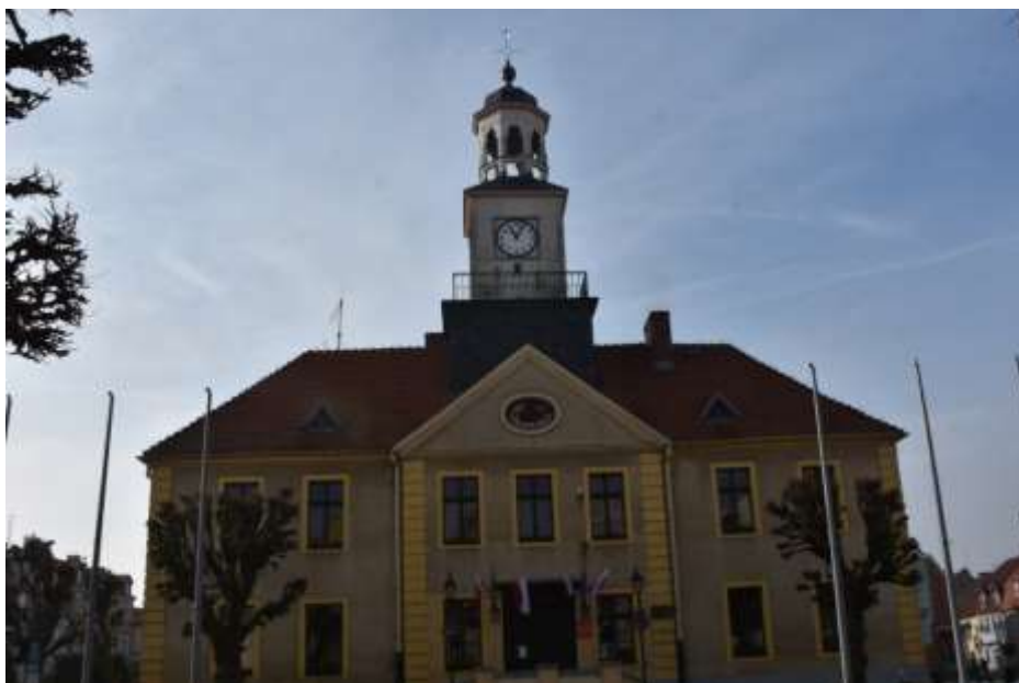
Fot. 282. Fragment elewacji: wieża składająca się z 3 odcinków: dolna część na planie zbliżonym do kwadratu, część środkowa na planie kwadratu z tarczą zegarową oraz latarni na planie ośmioboku;
