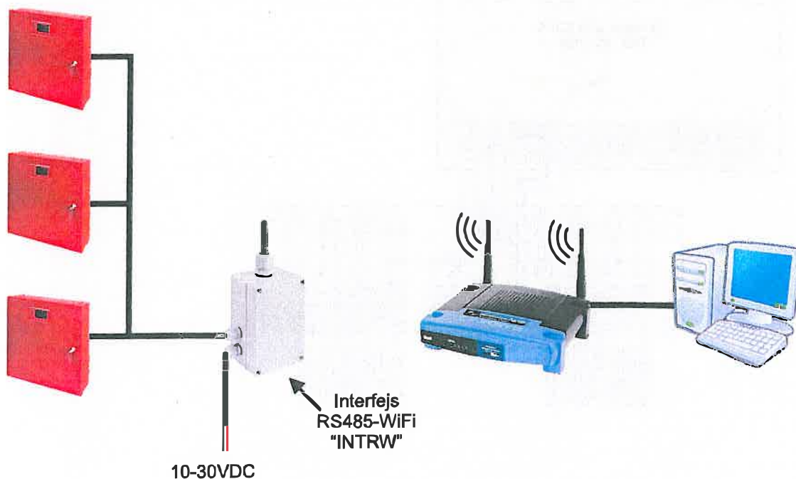
Komunikacja WI-FI z wykorzystaniem interfejsu RS485-WIFI „INTRW”.
