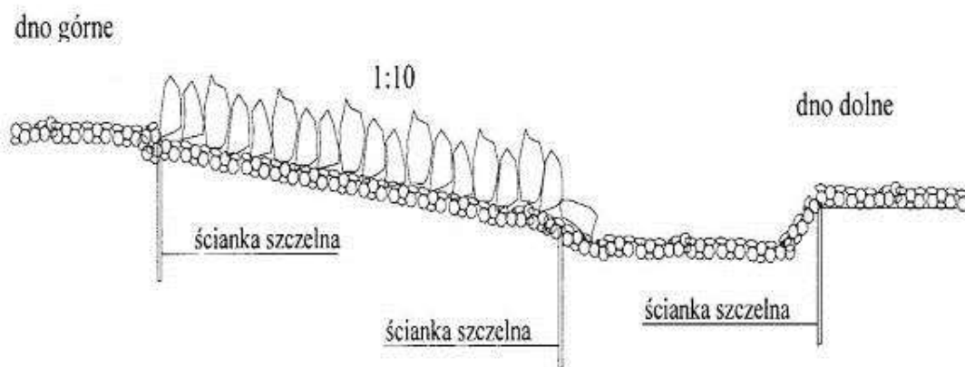
Schemat bystrza o zwiększonej szorstkości typu Vincenta (Radecki-Pawlik 2008, 2009)
