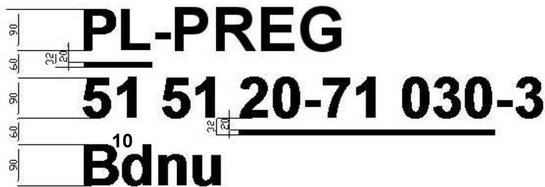
rys. 7.1.1 w części środkowej ściany bocznej wagonu.
