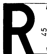
rys. 7.8.12. hamulec dużej mocy, którego efektywność hamowania jest niższa niż przewidziana kartą UIC 546 (procent masy hamującej 121... 149%).
