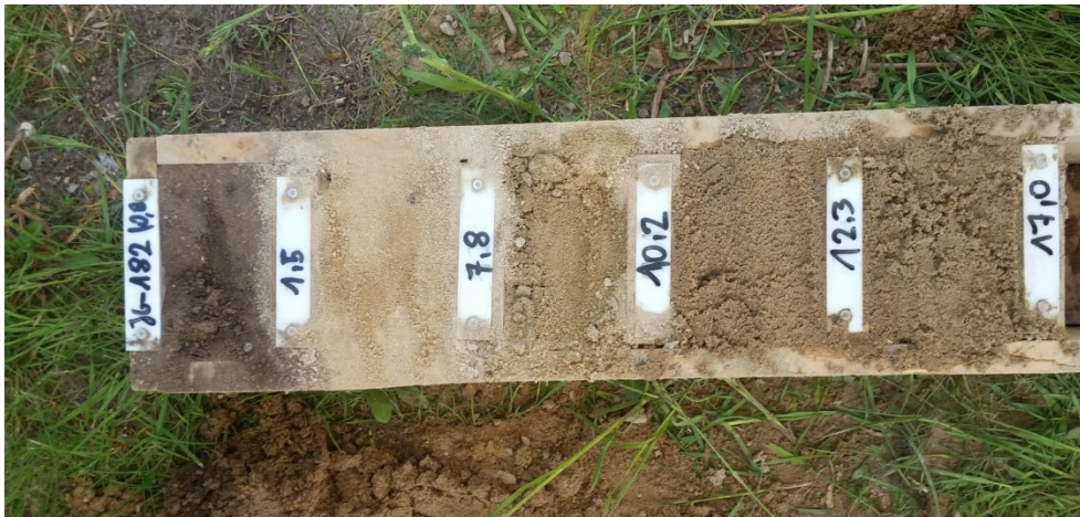
Fot. 1 Przykład dokumentowania fotograficznego przewierczanych gruntów
