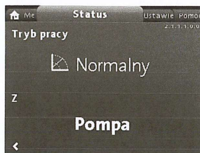
Rys. 59 Przykład podmenu "Status pracy", pokazującego pompę pracującą w trybie pracy normalnej w instalacji wielopompowej.
