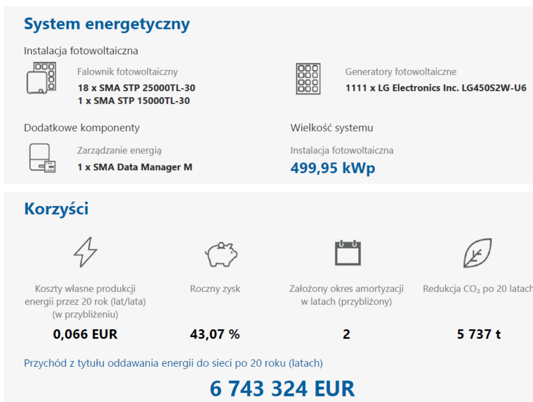
Rys.10. Wyniki analizy korzyści wynikających z zainstalowania omawianej instalacji fotowoltaicznej wygenerowane przez program Sunny Design 5.0.2.R
