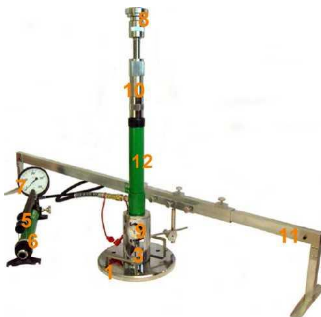
Rys. 1.2 Aparatura VSS z jednopunktowym pomiarem przemieszczenia płyty
