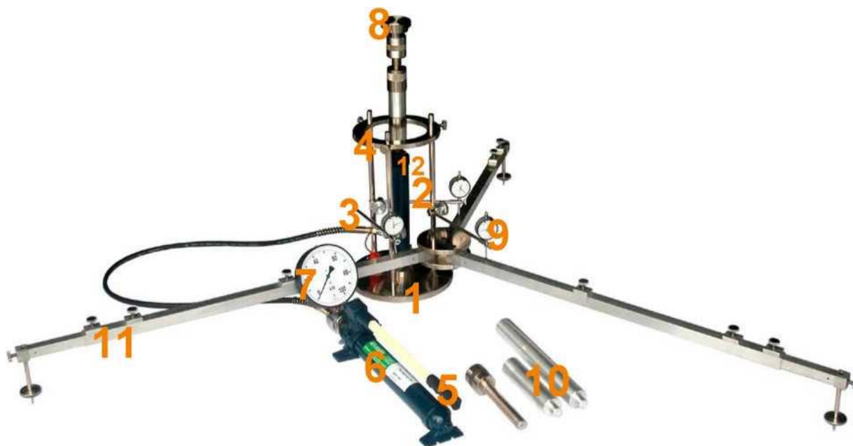
Rys. 1.1. Aparatura VSS z trzypunktowym pomiarem przemieszczenia płyty
