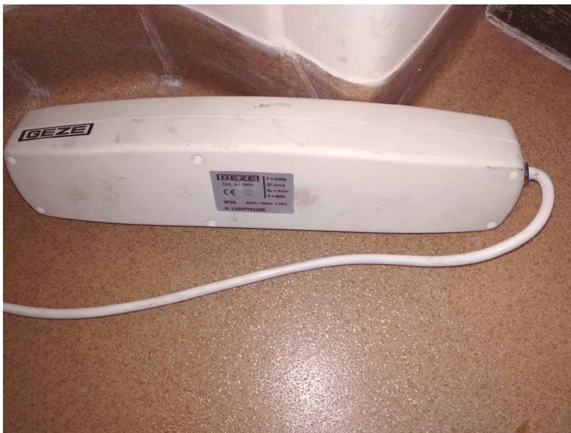
Fotografia nr 7: Widok na siłownik okienny (1 z 7 - materiały powierzone przez Zamawiającego)
