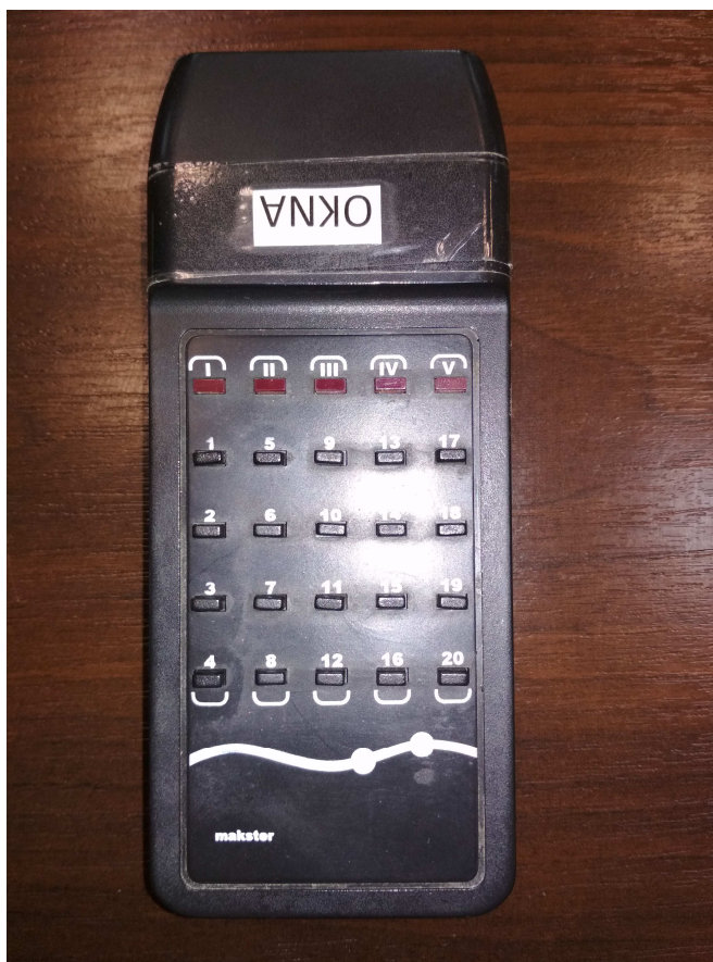
Fotografia nr 9: Pilot zdalnego sterowania siłownikami okiennymi na Sali im. Prof. Koskowskiego
