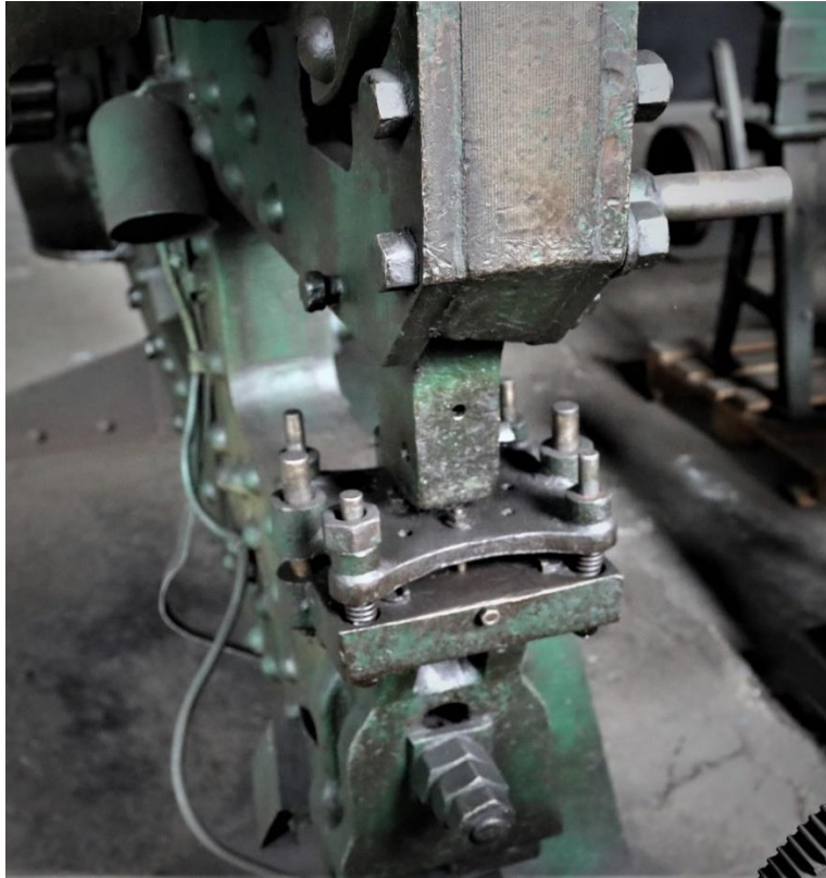
Fot.16 Widok gniazda wybijań otworów
