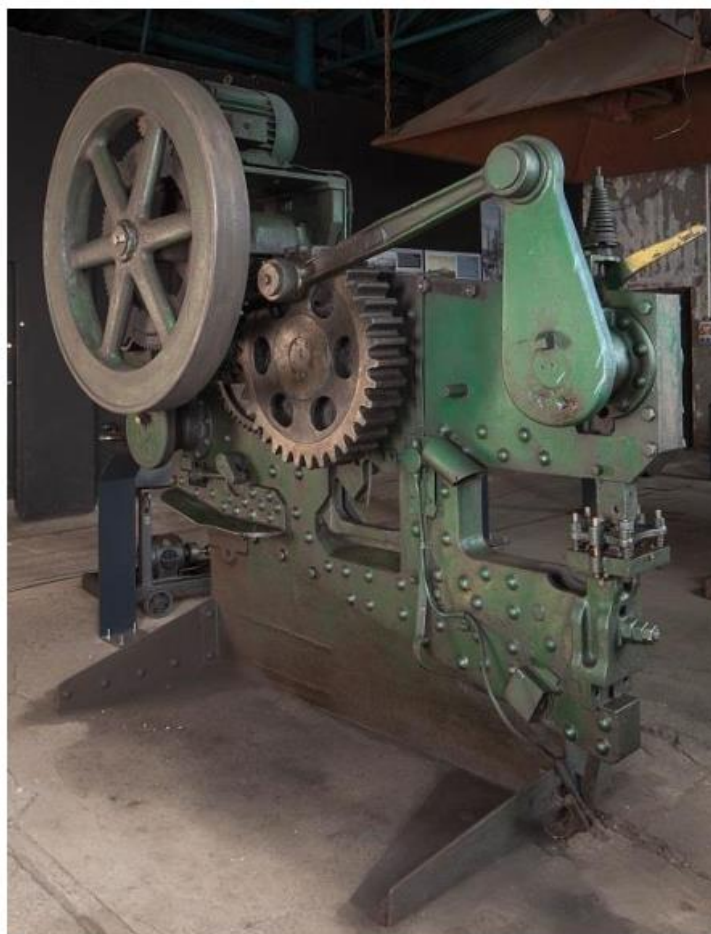
Fot.18 Korbówód w górnym położeniu
