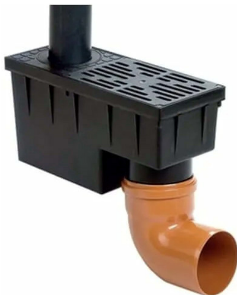
Fot. 4. – Przykładowy osadnik z syfonem i filtrem pod rurę spustową, służący do połączenia rewizyjnego rur spustowych z kanalizacją i zatrzymywania ew. zanieczyszczeń spływających z dachu [np. wg 'GRAF'; www.graf.info ]
