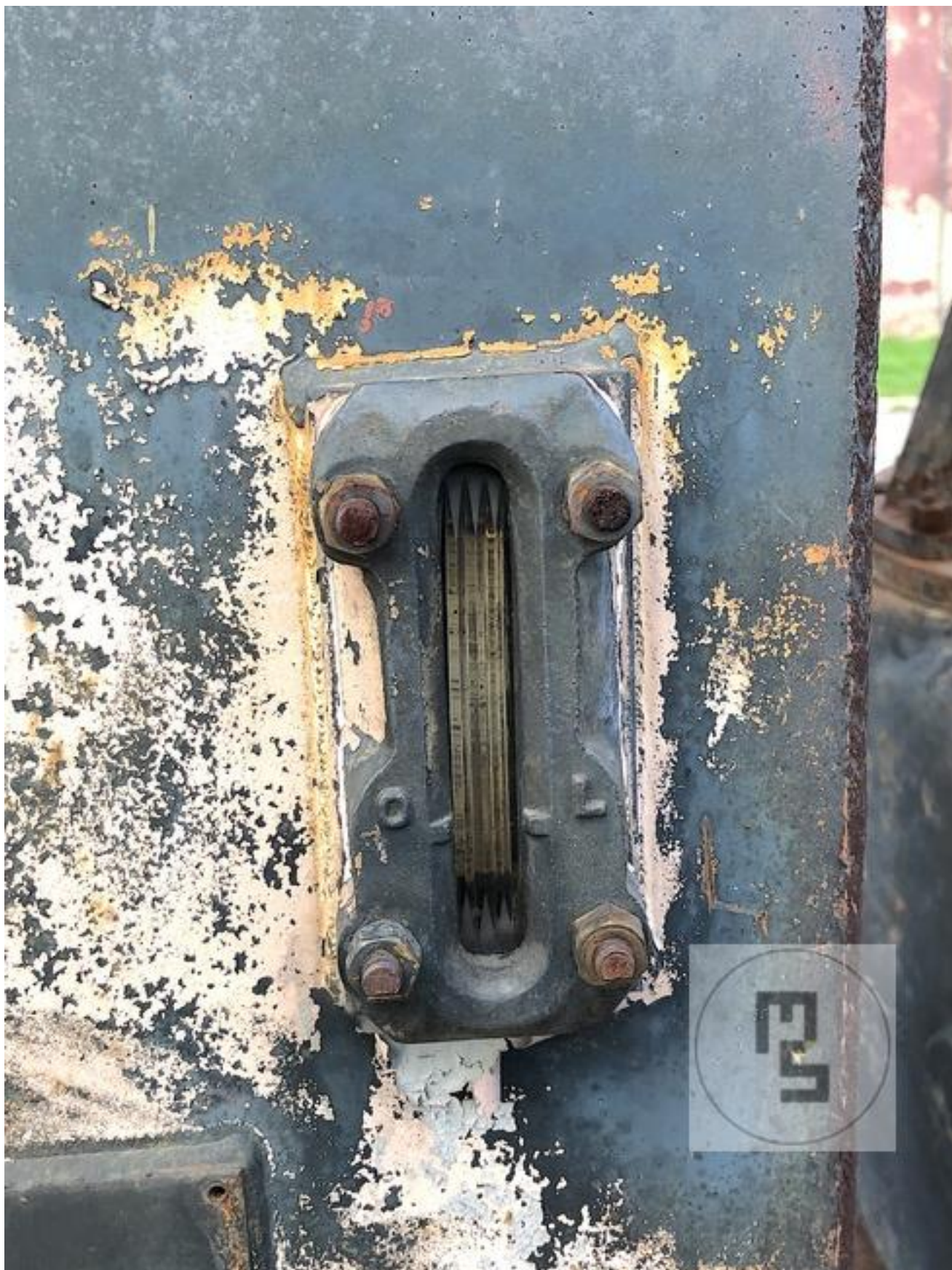
Fot. 2 Stan zachowania, wskaźnik poziomu oleju
