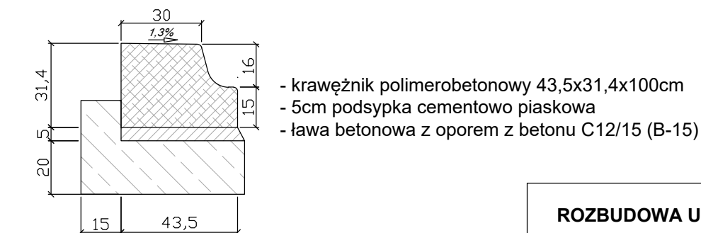
KRAWĘŻNIK POLIMEROBETONOWY 43,5x31,4x100cm
