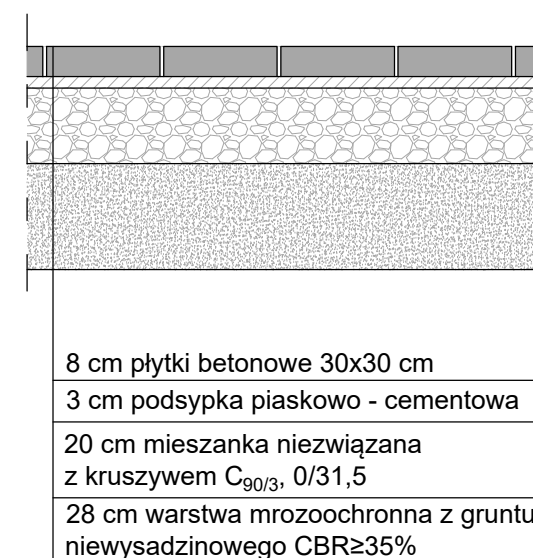
[6] Konstrukcja chodnika przejezdnego
