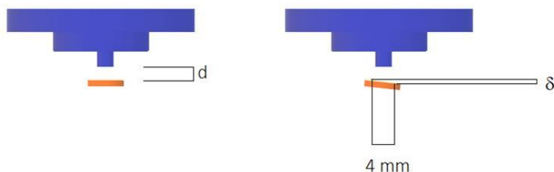
Rys. 3. Odległość katody prądu ciemnego d od wtyczki i różnice odległości \delta wynikające z nierównoległości.
