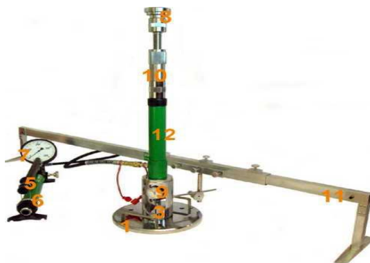
Rys. 1.2. Aparatura VSS z jednopunktowym pomiarem przemieszczenia płyty
